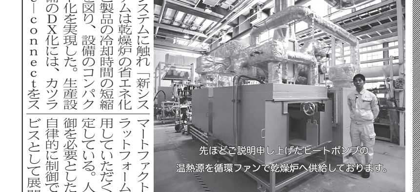
東京ガス千住テクノステーションB館に設置したハイブリッド塗装乾燥システムの試験機
